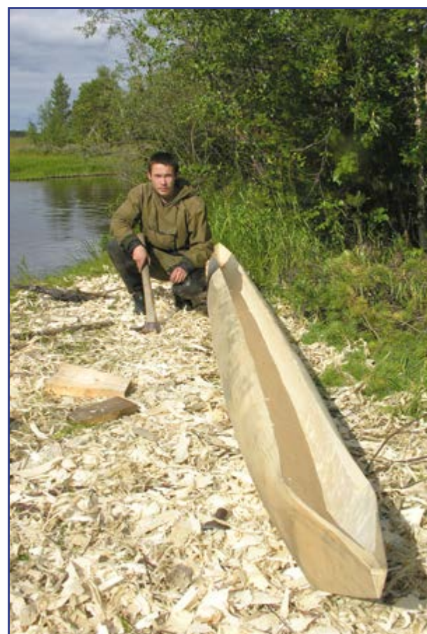
Процесс изготовления обласа. На стойбище Прасиных. Корлики.
