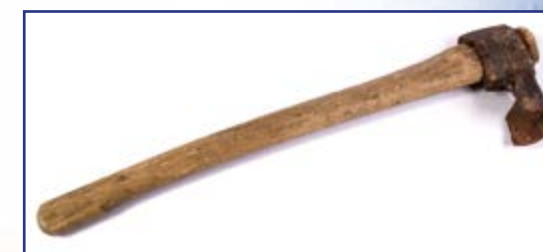
Тесло - инструмент для работы над обласом
