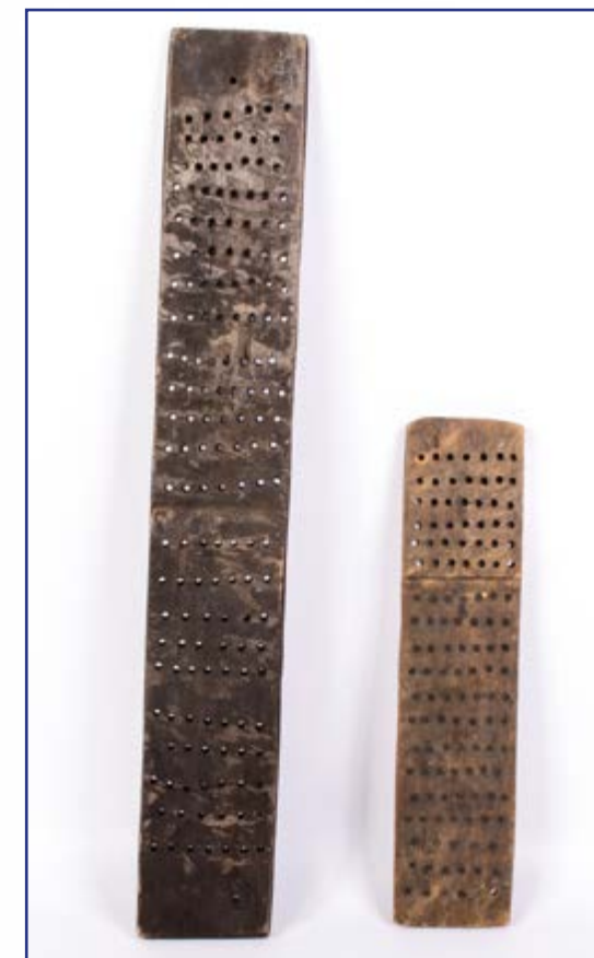
Мерка - для определения толщины стенок обласа
